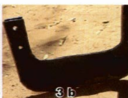
Photo 3. Vue de profil des pièces travaillantes de gauche à droite : a) Lame à 6 dents ; b) Lame sans dent arquée ; c) Lame racleuse.
